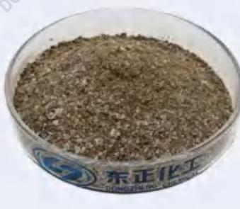
【物理化学性质】随钻堵漏剂（改性植物纤维）主要由天然材料，经科学配方生产而成。其主要成份为高活性腐植酸盐及其衍生物、纤维素、植物胶、聚戊糖等。外观呈可流动性固体粉末。是一种用于钻井液中降低滤失保护储层的封堵材料。
